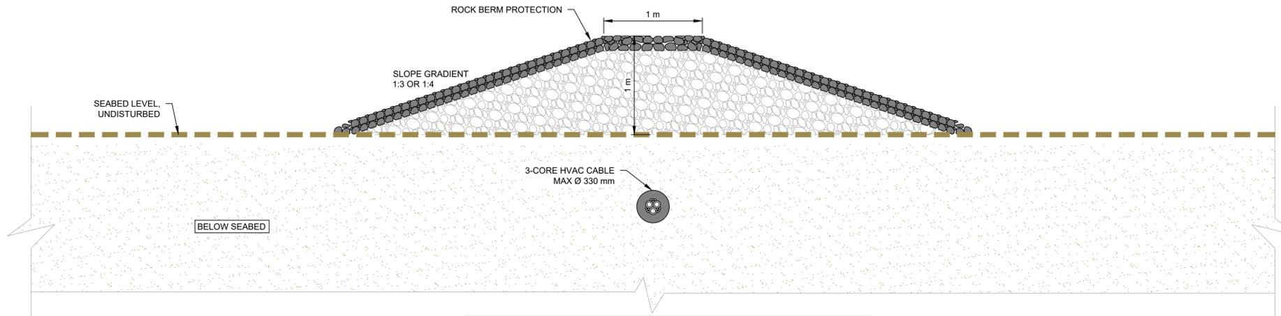
**ROCK BERM PROTECTION - ELEVATION VIEW**
